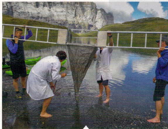
Le bout de la nasse forme une sorte de chaussette qui permet de retenir les particules les plus fines extraites du lac.
