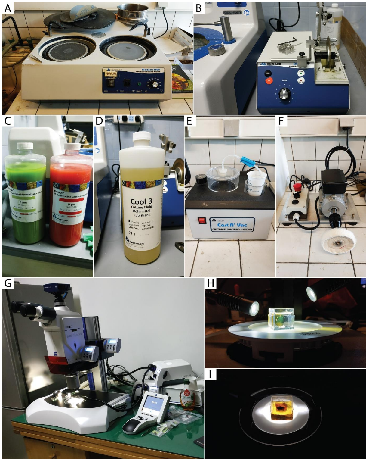
Figure 30. Principaux outils de préparation et d'observation pour les inclusions dans l'ambre. A, polisseuse Buehler Metaserv 3000 ; B, tronçonneuse de précision à basse vitesse IsoMet™ ; C, produits à suspension diamantée utilisés pour optimiser la qualité et la durée du polissage ; D, fluide de coupe (liquide de refroidissement) aidant à dissiper la chaleur et à supprimer les copeaux sur le point de coupe ; E, pompe à vide pour l'incorporation d'ambre dans de la résine « Époxy » ; F, brosse de finition pour le polissage ; G, stéréomicroscope Zeiss Axio Zoom.V16 et sa source lumineuse ; H, utilisation conjointe de LED à fibre optique avec fragment d'ambre plongé dans une solution de glucose à 60-70% pour réduire les effets de réverbération et de diffraction ; I, fragment d'ambre plongé dans du sirop d'agave avec lumière convergente ajustée. Illustrations : C. Chény.
